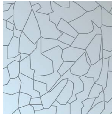
Cristal de seguridad monocapa
