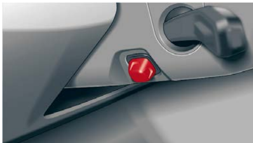
Ajuste eléctrico de la posición del volante
