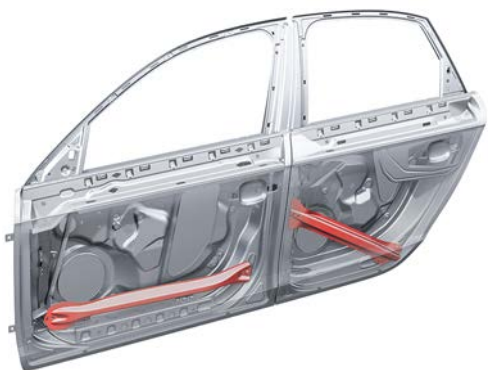
Protección lateral anticolidión en las puertas
