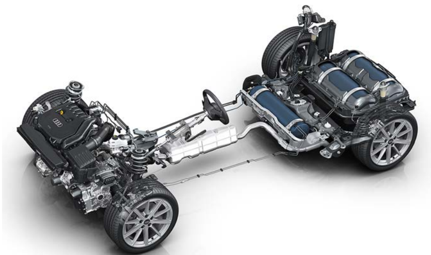
Audi a3 g-tron con 3 depósitos de gas
