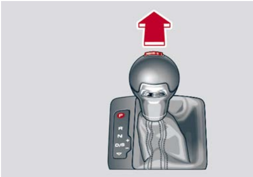
Vehículo con cambio automático con palanca selectora: poner la palanca selectora en la posición "P"
