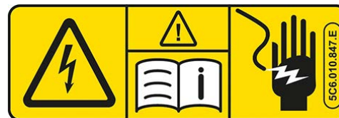
Ejemplos de adhesivos de advertencia en vehículos de alto voltaje.
