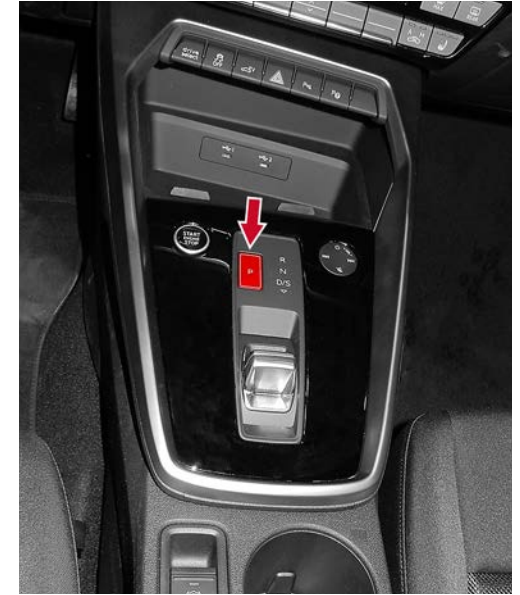
Vehículo con cambio automático sin palanca selectora: pulsar la tecla "P"
