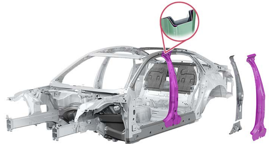
Pilar B con estructura de varias chapas
