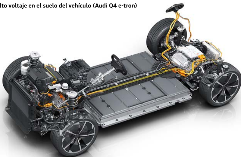
Batería de alto voltaje en el suelo del vehículo (Audi Q4 e-tron)
