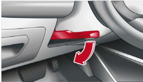
Ajuste manual de la posición del volante
