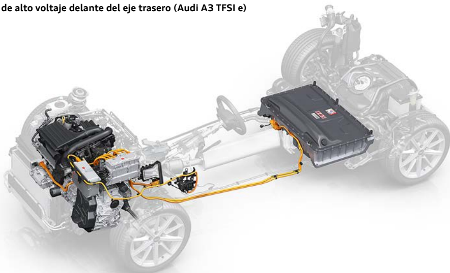
Batería de alto voltaje delante del eje trasero (Audi A3 TFSI e)
