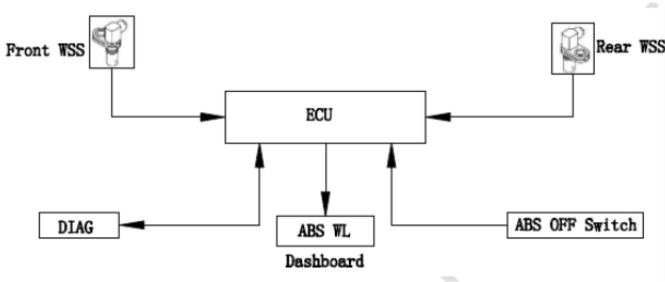
Señales de velocidad de la rueda del vehículo detectadas por sensores de velocidad de la rueda (WSS) y enviadas a la ECU. Cuando las ruedas tienden a bloquearse, la ECU controlará el sistema de frenado cuando identifique esta información. Podemos sentir este proceso de ajuste al golpear levemente en el mango del freno delantero o el estribo trasero.
