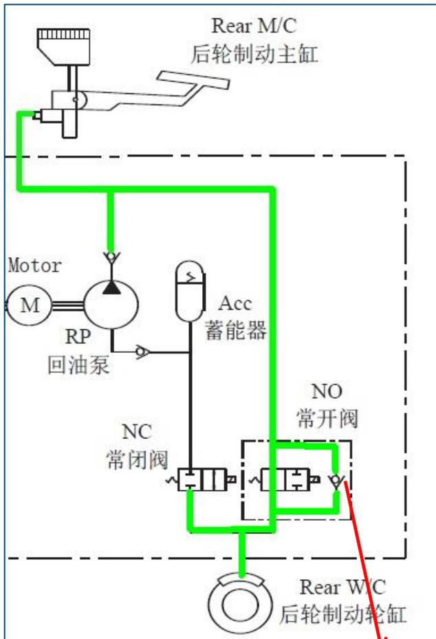
Esta válvula unidireccional es una válvula de alivio de seguridad, diseñada para liberar la presión cuando la válvula de entrada está atascada en casos extremos raros
